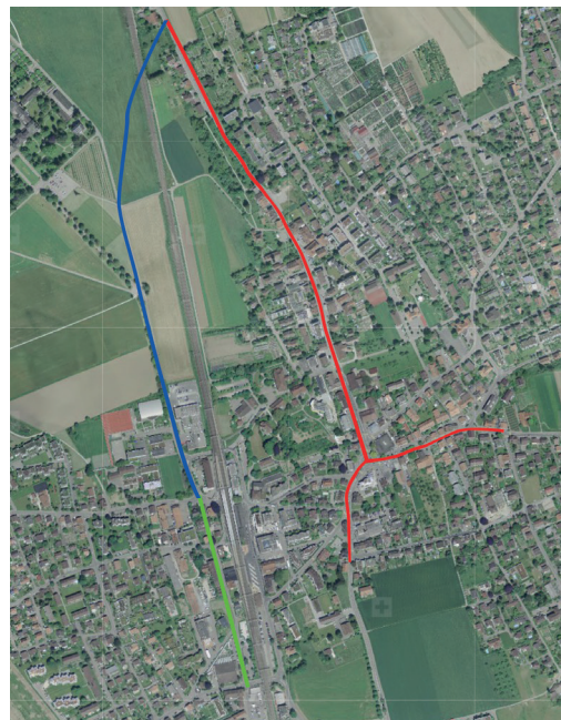
Lösung im Dreierpack: Sanierung der Ortsdurchfahrt (rot), Entlastungsstrasse Nord (blau), Verbindung Industriestrasse (grün)
