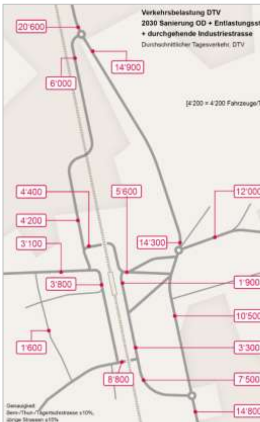
Verkehrsbelastung DTV 2030 mit Sanierung der Ortsdurchfahrt + Entlastungsstrasse Nord + durchgehende Industriestrasse
